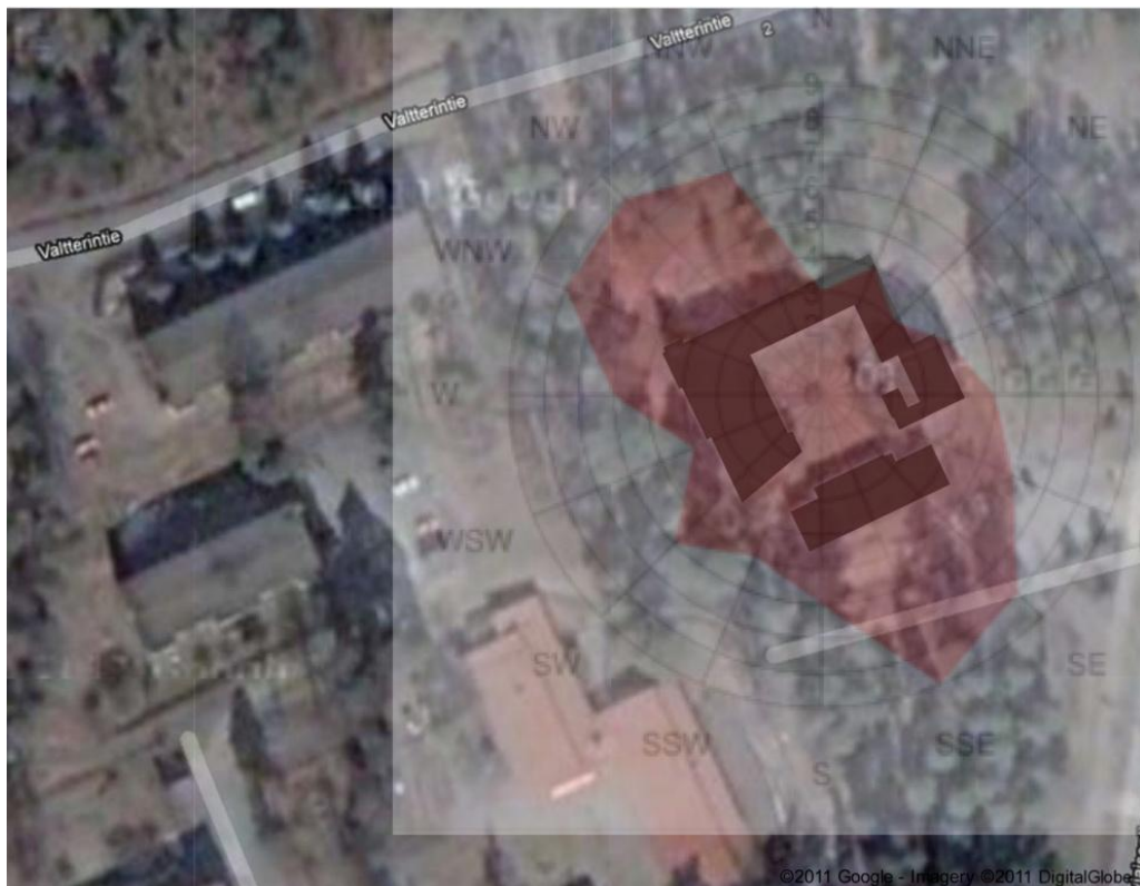
Figure 3: Prevailing wind directions at Säynätsalo
