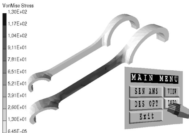
Figure 4 : VIRTUAL ENVIRONMENT FOR ENGINE CONNECTING ROD SHAPE DESIGN
