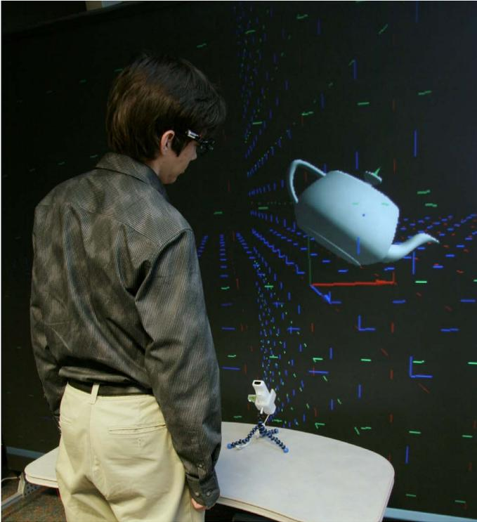
**FIGURE 2. HEAD TRACKING DATA SHOWN AS TEAPOT**
