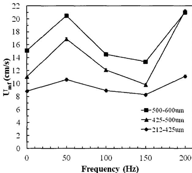
FIGURE 4: MINIMUM FLUIDIZATION VELOCITY AS A FUNCTION OF FREQUENCY FOR GLASS BEADS AT  $H/D = 0.5$ .
