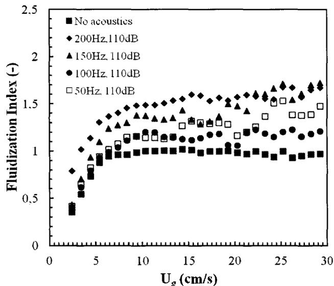
FIGURE 5: FLUIDIZATION INDEX AS A FUNCTION OF SUPERFICIAL GAS VELOCITY FOR GLASS BEADS 212-425  $\mu\text{m}$  AT  $H/D = 0.5$ .
