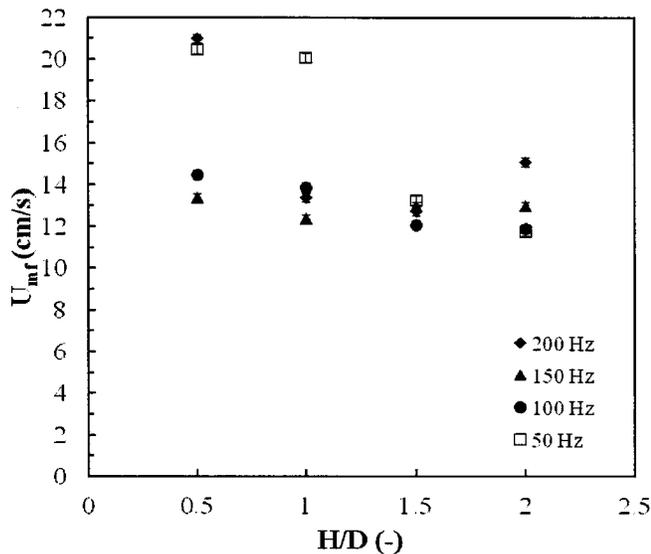
**FIGURE 7: MINIMUM FLUIDIZATION VELOCITY AS A FUNCTION OF BED HEIGHT FOR 500-600  $\mu\text{m}$  GLASS BEADS.**
