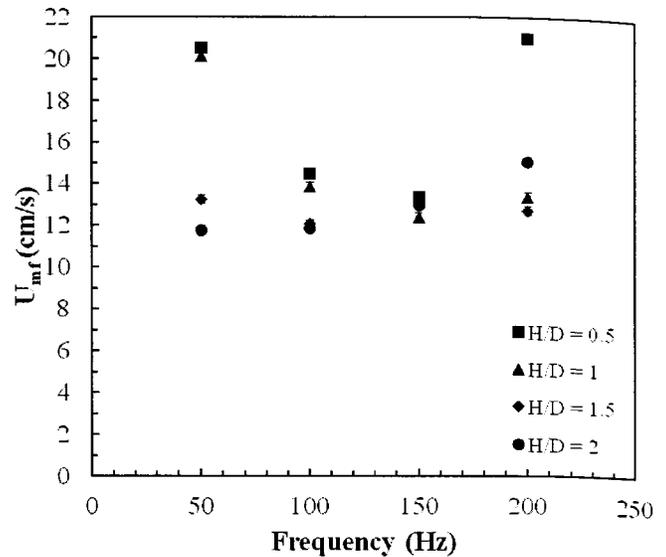
**FIGURE 8: MINIMUM FLUIDIZATION VELOCITY AS A FUNCTION OF FREQUENCY FOR 500-600  $\mu\text{m}$  GLASS BEADS AT DIFFERENT BED HEIGHTS.**
