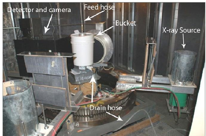
**FIGURE 2: THE JET IMPINGEMENT FLOW LOOP LOCATED IN THE X-RAY FLOW VISUALIZATION FACILITY; THE PUMP AND MOTOR CONTROLLER ARE OUT OF THE IMAGE TO THE RIGHT.**
