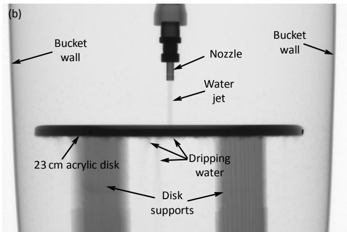
**FIGURE 3: THE IMPINGING JET DURING OPERATION: (a) A VISIBLE LIGHT PICTURE OF THE BUCKET INTERIOR WHERE THE CIRCULAR HYDRAULIC JUMP CAN BE SEEN SURROUNDING THE JET, AND (b) A SINGLE RADIOGRAPH OF AN IDENTICAL PROCESS.**
